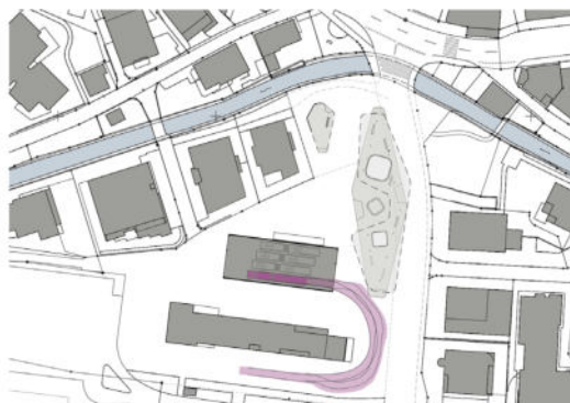
SCHLEPPKURVE DEPOTAUSFAHRT BUS 4
